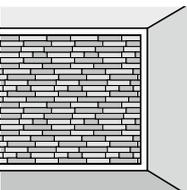
Lassen Sie zum Boden, zur Decke und seitlich jeweils min. 1 cm Luft (bei ca. 2,4 m Raumhöhe), damit sich das Holz beim Feuchteausgleich etwas bewegen kann.
