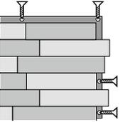
Befestigen Sie die erste Platte mit Senkkopfschrauben. Drehen Sie die Schrauben noch nicht komplett fest.
