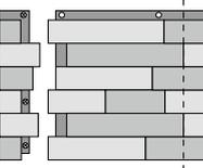
Fahren Sie immer so fort. Beim Wandanschluss rechts schneiden Sie die Platte passend gerade ab.
