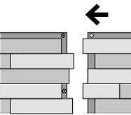
Schieben Sie die nächste Platte in die erste befestigte Platte bis fast an die Schrauben. Drehen Sie diese nun fest. Schieben Sie die Platten jetzt dicht zusammen.
