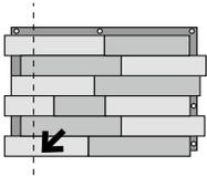
Am einfachsten beginnen Sie in der Ecke unten links. Schneiden Sie die erste Platte an der linken Seite gerade ab.
