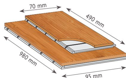
Dieses 2-Schichtparkett besteht aus einer Nuttschicht aus Bambus und einem Unterzug aus Fichten-/Kiefern lamellen, die, um 90 Grad gedreht, mit der Nuttschicht verleimt sind. Diese Konstruktion verringert das Quell- und Schwindverhalten erheblich. Aus diesem Grund gilt 2-Schichtparkett auch als die beste Variante für das Verlegen auf Fußbodenheizung.
